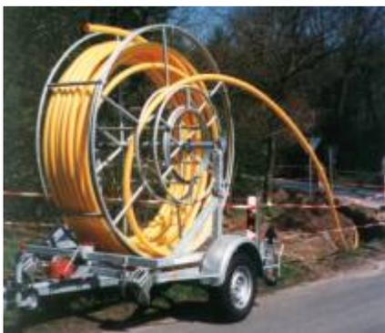
Die Haspelkörper RH 40 und RH 63 sind auch ohne Standgestell im Kabelwagen einsetzbar.
