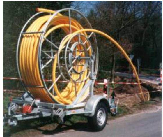
**Beide Baureihen werden in verzinkter Ausführung mit Einachsahrgestell und Auflaufbremse geliefert.**
