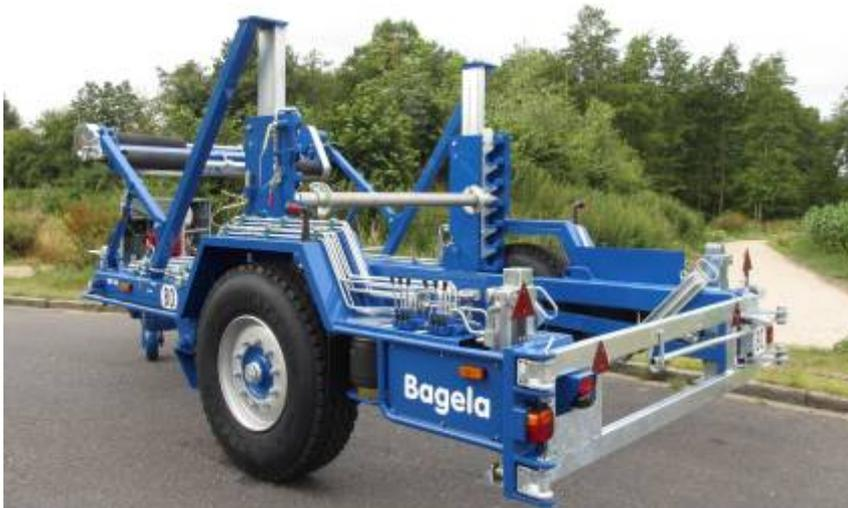
Von zwei vertikal angeordneten Hubtaschenreihen wird die Trommel eingehoben. Die Hubtaschenreihen werden motorhydraulisch betrieben, sind einzeln steuerbar und werden von Traglastsicherungsbolzen festgesetzt.
