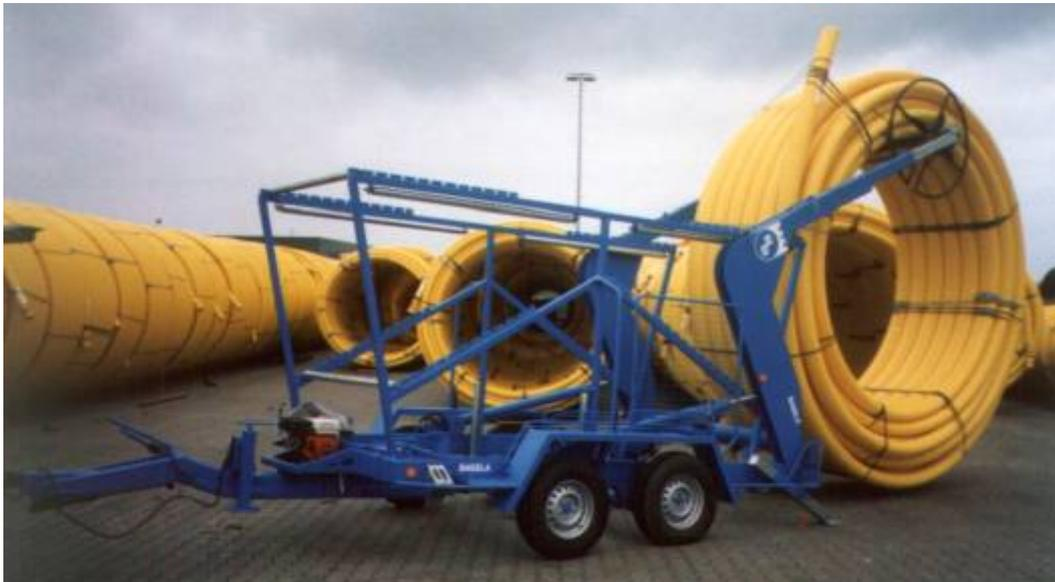
Der BRT 20 kann liegende Rohrbunde ohne fremde Hilfe aufnehmen, einladen und abspulen. Mit Hilfe der senkrechten, hydraulischen Stützenträger werden die Rohrbunde unterschiedlicher Durchmesser auf die unteren Tragrollen abgesenkt. Danach werden drei innere Führungsrollen eingesetzt und mit Klappsplint gesichert, das Rohrbund ist abspulbereit.
