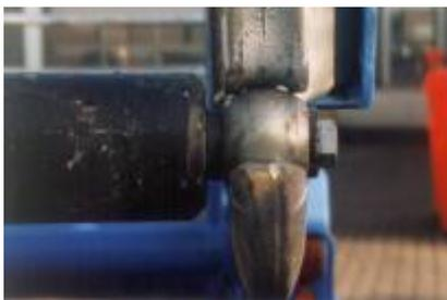
Die Aufnahmeachse ist als gelagerte Laufrolle gefertigt und an dem Enden mit kugelförmigen Lagerzapfen versehen. Dadurch ist gewährleistet, dass die Achse auch bei unterschiedlich weit ausgefahrenen Hubarmen nicht verspannt wird. Mit zwei Begrenzungsrädern werden die schmalen 100m Bunde in der Achsmittle gehalten.
